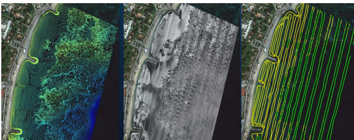
Figure 3. De gauche à droite : Isobathes (micro-rugosité bathymétrique) - Imagerie sonar latéral - SACLAF (Détection herbier en vert - Sédiment en jaune). Taille des zones : 500 m par 300 m.
