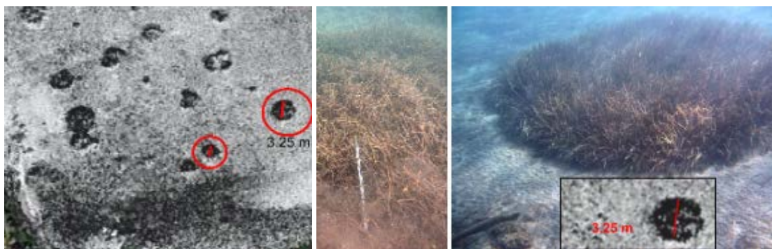
Figure 4. Calibration sonar & Vérité terrain (Utilisation d'un mètre linéaire métallique). Diamètre mesuré en plongée : 3.25 m
