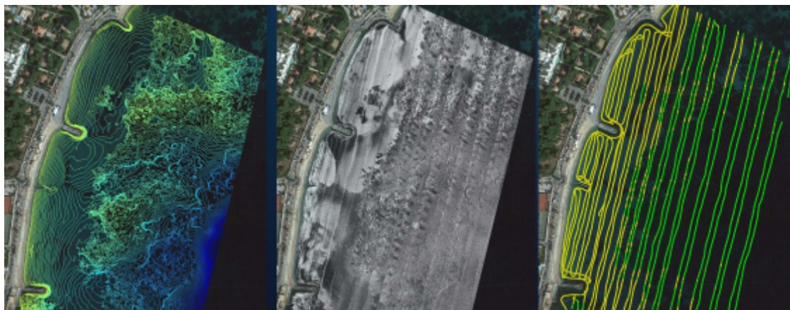
Figure 2 : De gauche à droite : (A) Isobathes (micro-rugosité bathymétrique) - (B) Imagerie sonar latéral (C) Classification acoustique (Détection végétation en vert - Sédiment en jaune). Taille des zones : 500 m par 300 m
