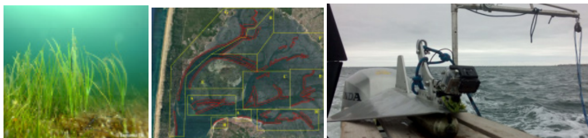
Figure 3 : Mise en œuvre de la méthode de monitoring par fusion multi-capteurs pour le suivi des zostères De gauche à droite : Zostera marina - Zone monitorée – Vidéo tractée de vérité terrain (retour temps-réel de la vidéo)
