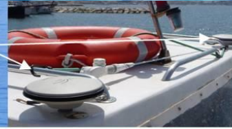
Centrale Attitude : 2 GPS RTK couplés à une Centrale Inertielle
